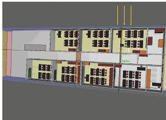
Сл. 6. Симулациони модел лабораторијског дела Електротехничке школе „Никола Тесла“ у Нишу, са означеним местима за проток ваздуха и детекторима, у програму PyroSim Fig. 6. Simulation model of the laboratory part of the Electro technical school "Nikola Tesla" in Niš, with marked places for air flow and detectors, in PyroSim software
