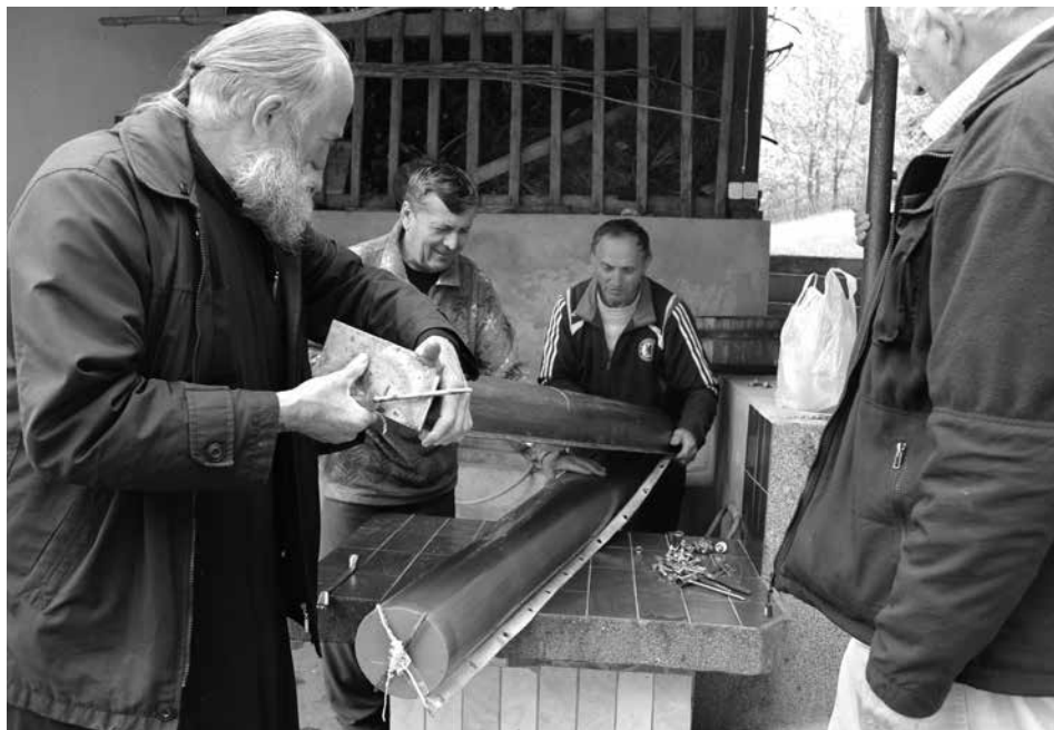
Слика 5. Отварање калупа и вађење изливене свеће у манастиру Троноша, април 2022. године. На фотографији су архимандрит Николај, духовник манастира Троноша и ливачи свеће
