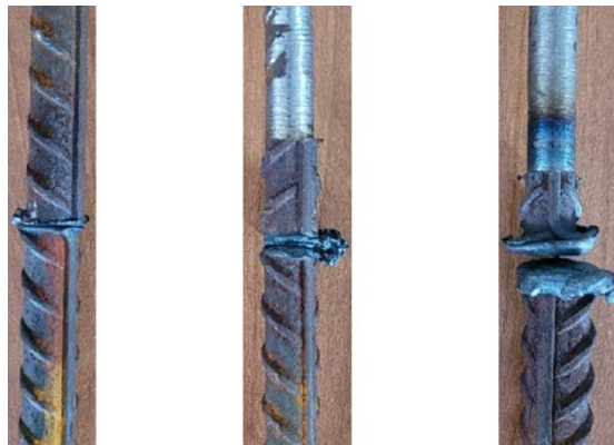
Fig. 8. \varnothing 14\text{mm} sample welded in mode 4 ( t_n=25\text{s} , n=2000\text{ rpm} ).
