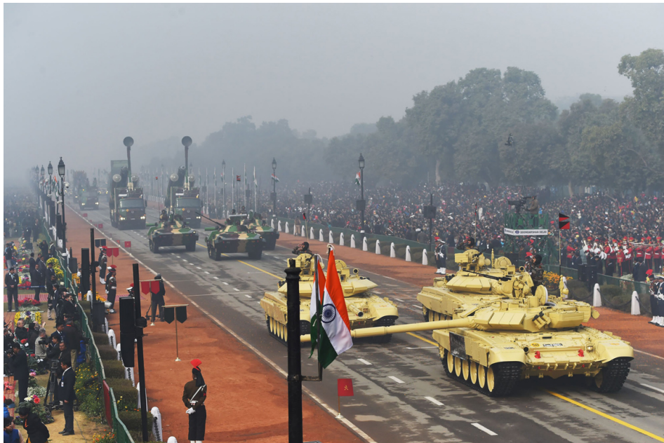
Индијски тенк „Бишма” наоружан је топом 2А46М-1 са ожлебљеном цеви 125 мм
