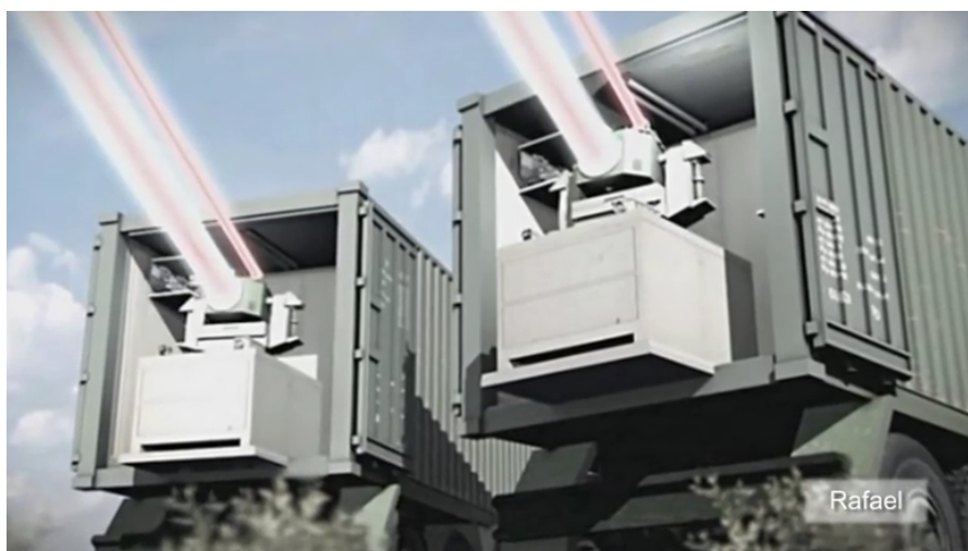
Ласер који је намењен онеспособљавању ракета, минобацачких мина и беспилотних летелица
