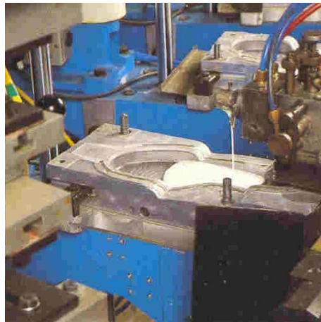
Figure 11 – Casting mixture into the tool Рис. 11 – Заливка форм смесью Слика 11 – Уливање смеше у алат
