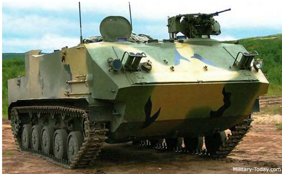
Уздигнут је простор за десантно одељење, али митраљез РКМ 7,62 мм није стабилизван
