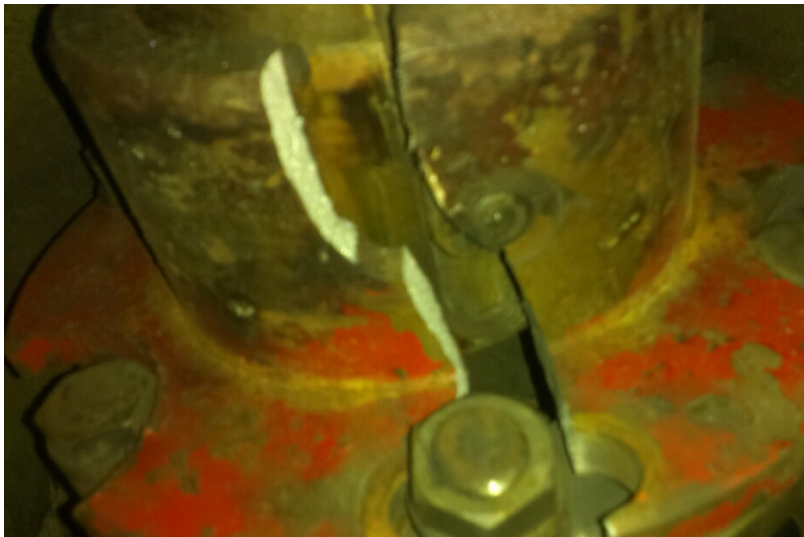
Figure 3 – Broken flange of the elastic coupling on the mini hydro generator flywheel Рис. 3 – Изображение сломанного фланца упругой муфты на оси генератора мини-ГЭС Слика 3 – Приказ поломљене прирубнице еластичне спојнице на осовини генератора мини-хидроелектране
