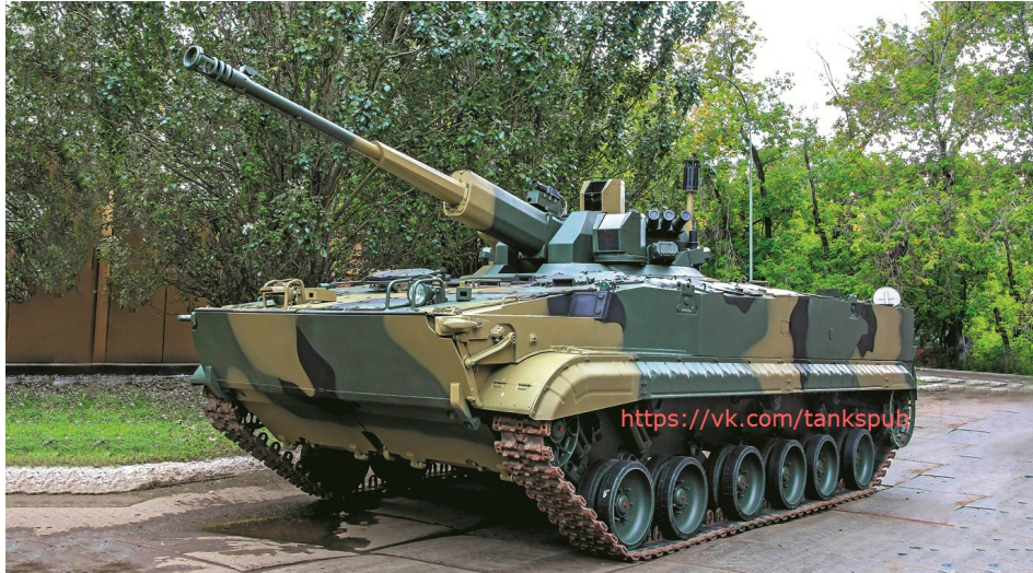
Купола AU-220M наоружана топом 57 мм на руском борбеном возилу пешадије BMP-3
