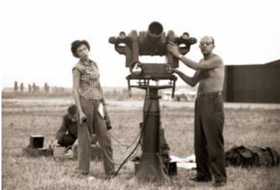
Figure 3 – Pre-war cinetheodolite (Arhiv Vazduhoplovnog opitnog centra, 2016), Рисунок 3 – Довоенный кинотеодолит (Arhiv Vazduhoplovnog opitnog centra, 2016) Слика 3 – Предратни кино теодолит (Arhiv Vazduhoplovnog opitnog centra, 2016)
