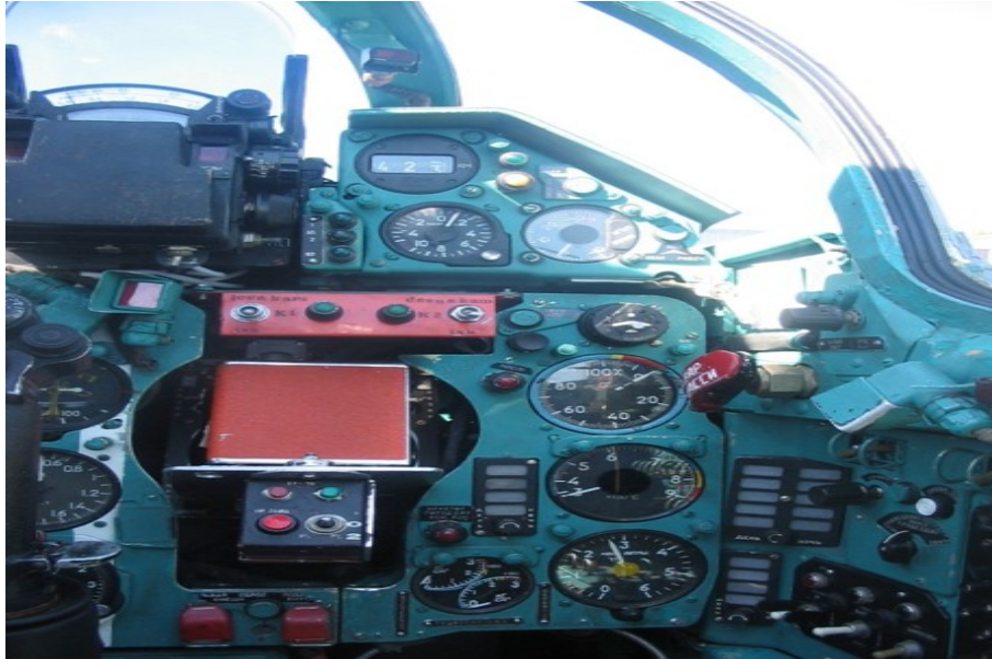
Figure 4b – A20 installed on an MIG 21 (Arhiv Vazduhoplovnog opitnog centra, 2016) Рисунок 4б – А20 установленный в самолете МиГ 21 (Arhiv Vazduhoplovnog opitnog centra, 2016) Слика 4б – А20 уграђен на авион МиГ 21 (Arhiv Vazduhoplovnog opitnog centra, 2016)
