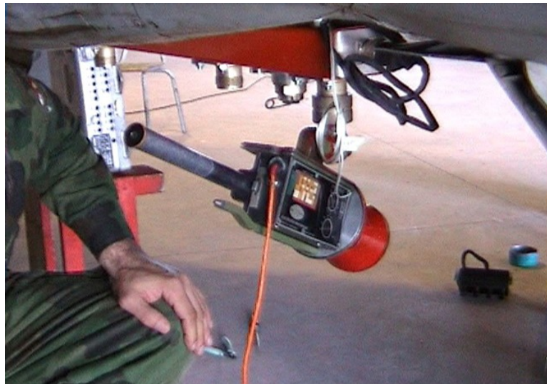
Figure 8 – AVIA camera (Arhiv Vazduhoplovnog opitnog centra, 2016) Рисунок 8 – AVIA камера (Arhiv Vazduhoplovnog opitnog centra, 2016) Слика 8 – AVIA камера (Arhiv Vazduhoplovnog opitnog centra, 2016)
