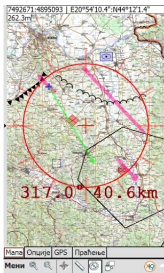
Figure 1 – Example from the mobile GIS Forward Observer module (the crossed, red, diamond shaped signs describe an enemy infantry unit) Рис. 1 – Пример с модула мобилној географическој системи за подршку артиљерији (маркировка в виде крестика, црвене боје и црвеног ромба означава пешадијску јединицу противника)
