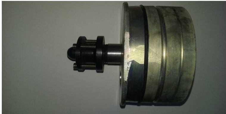
Figure 14 – Clamping tool with a laser pointer on the technological sleeve Рис. 14 – Зажимной инструмент с лазерным целеуказателем на технологической гильзе Слика 14 – Стезни алат са ласерским обележивачем на технолошкој чаури
