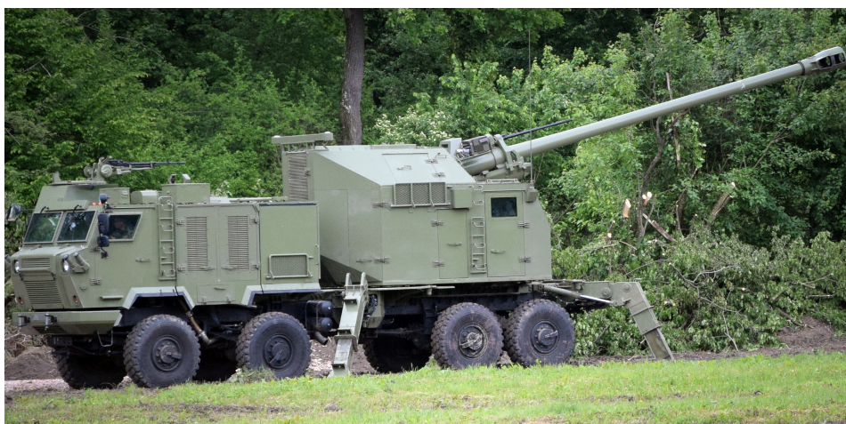
Самоходна хаубица НОРА Б-52, калибра 155 mm. Фото: Милош Јевтић
