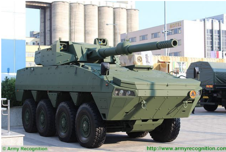
Wilk (вук) верзија оклопног возила Rosomak 8X8, опремљеног куполом Cockerill CV-105HP
