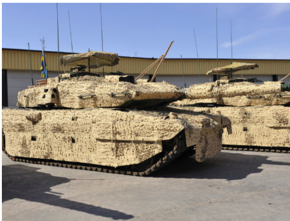
Мобилна прекривка Barracuda Mobile System (MCS) на тенку Leopard 2
