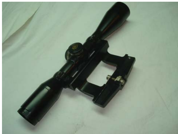
Figure 6 – ON 8 x 56m optical sight (Teleoptik-Gyros, 2018b) Рис. 6 – Оптический прицел ОН 8 x 56м (Teleoptik-Gyros, 2018b) Слика 6 – Оптички нишан ОН 8x56м (Teleoptik-Gyros, 2018b)
