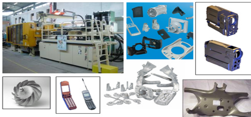
Slika 7 – Postrojenje za izvođenje Thixomoulding postupka sa modelima koji se izrađuju Figure 7 – Plant for Thixomoulding procedure with manufactured models
