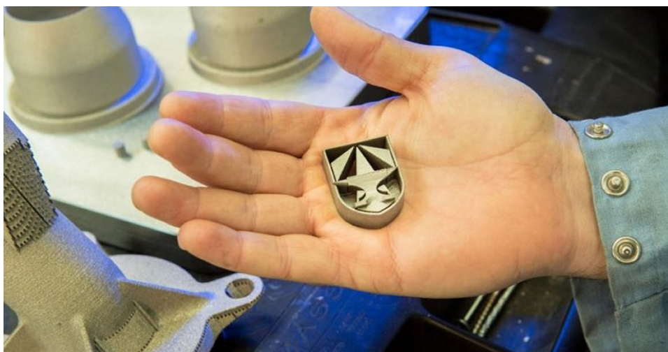
Метална легура AF96 коју је америчка војска развила за бомбе намењене пробијању бункера
