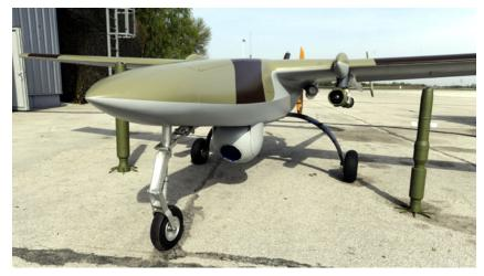
Figure 4 – Tactical unmanned aerial vehicle 'PEGAZ' (Dragović, 2016) Рис. 4 – Тактический беспилотный летательный аппарат «ПЕГАС» Слика 4 –Тактичка беспилотна летелица великог долета "ПЕГАЗ" (Dragović,2016)
