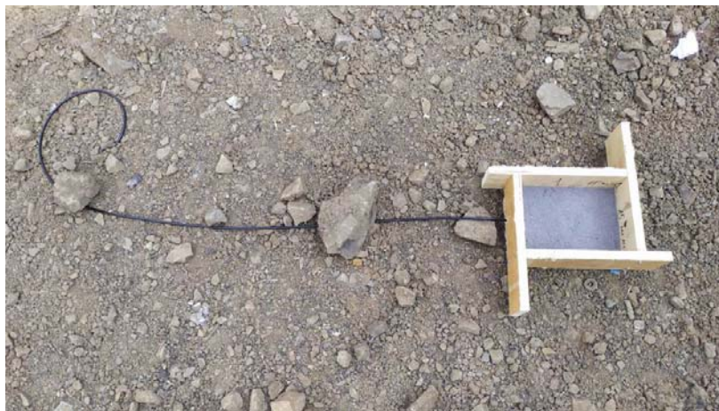
Figure 2 – Experimental setting for explosive welding Рис. 2 – Экспериментальная установка сварки взрывом Слика 2 – Експериментална поставка експлозивног заваривања
