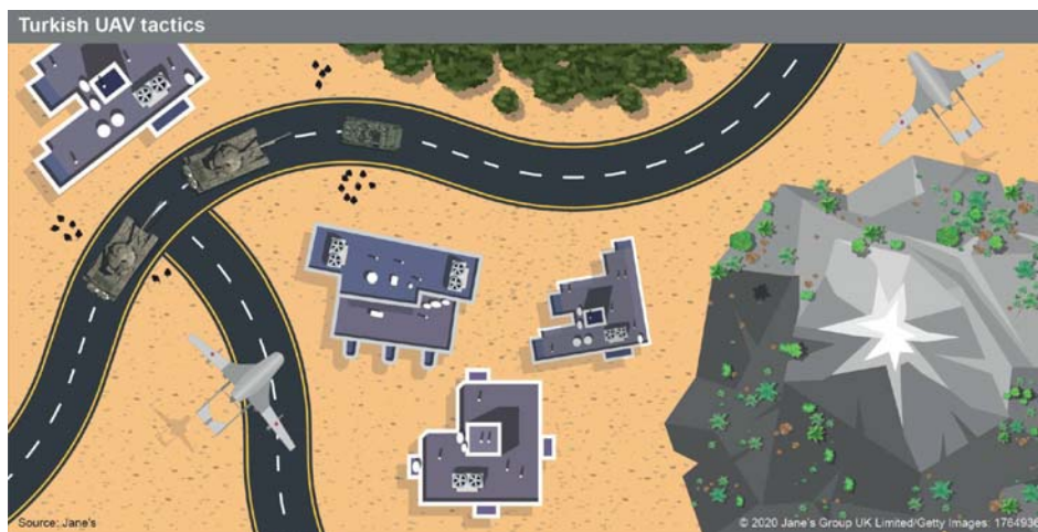
Координација две БПЛ Bayraktar TB2. Једна лети близу циља, омогућавајући ласерско вођење и врши координацију ракета које лансира друга БПЛ.
