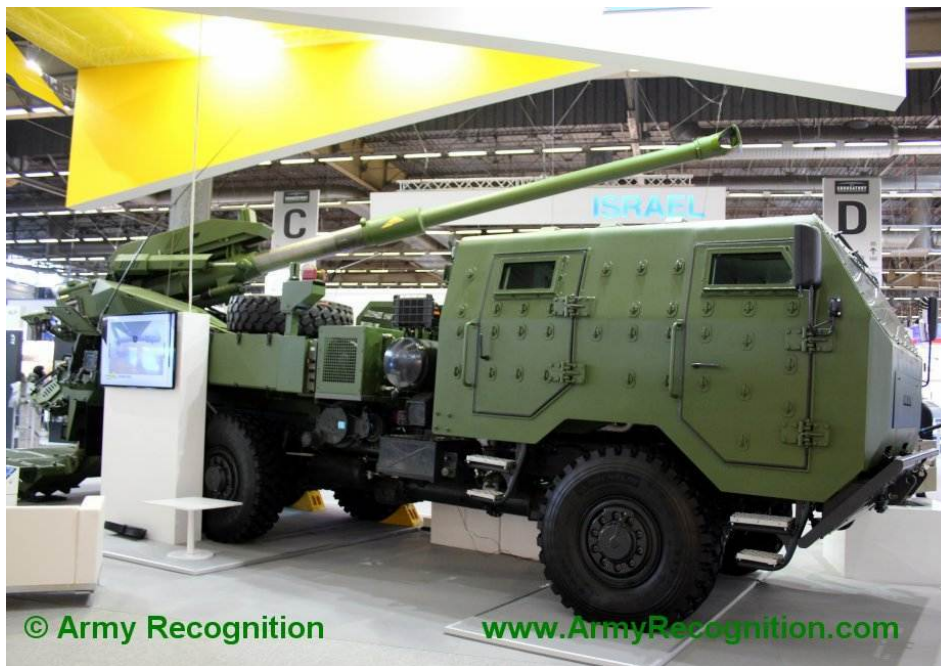
ATMOS самоходна хаубица точкаш са хаубицом Soltam Systems 155mm/52 (Фото: Army Recongition)
