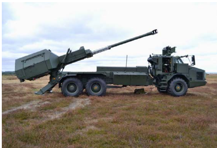
Самоходна хаубица Archer 155mm у конфигурацији 6x6
