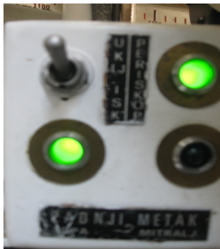
Figure 7 – Gunner's periscope heater switch Рис. 7 – Выключатель обогревателя перископа наводчика Слика 7 – Прекидач грејача перископа нишанџије
