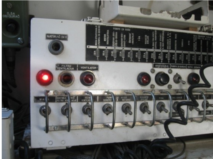
Figure 6 – Control panel in the BVP M-80A control section Рис. 6 – Панель управления в секции управления БВП М-80А Слика 6 – Контролна табла у управном одељењу БВП М-80А
