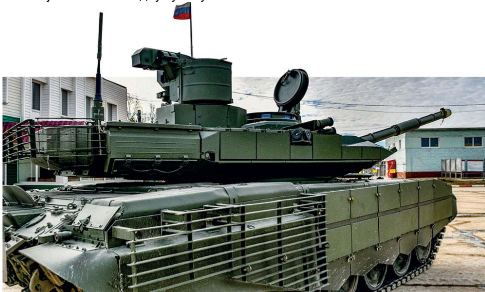
Одељак за смештај резервне муниције на тенку Т-90М који делује и као противтег предњег дела куполе.
