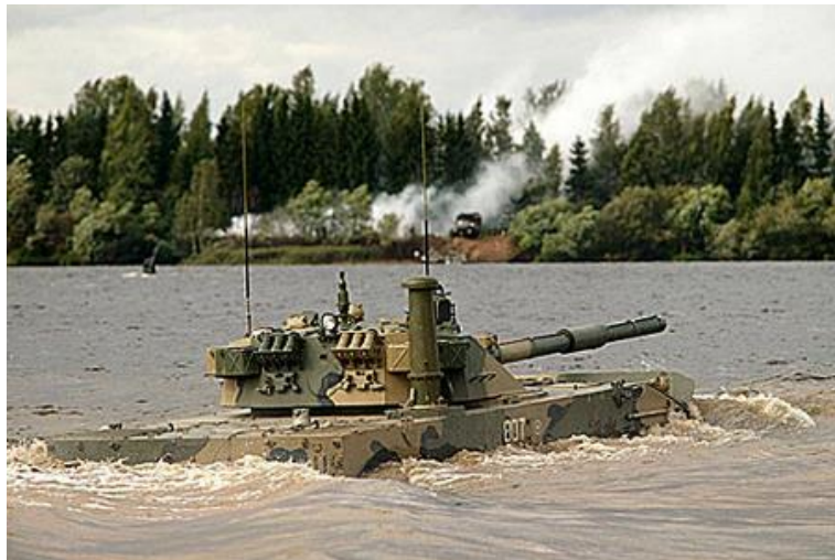
Амфибијска својства самоходног противтенковског топа Sprut-SDM1
