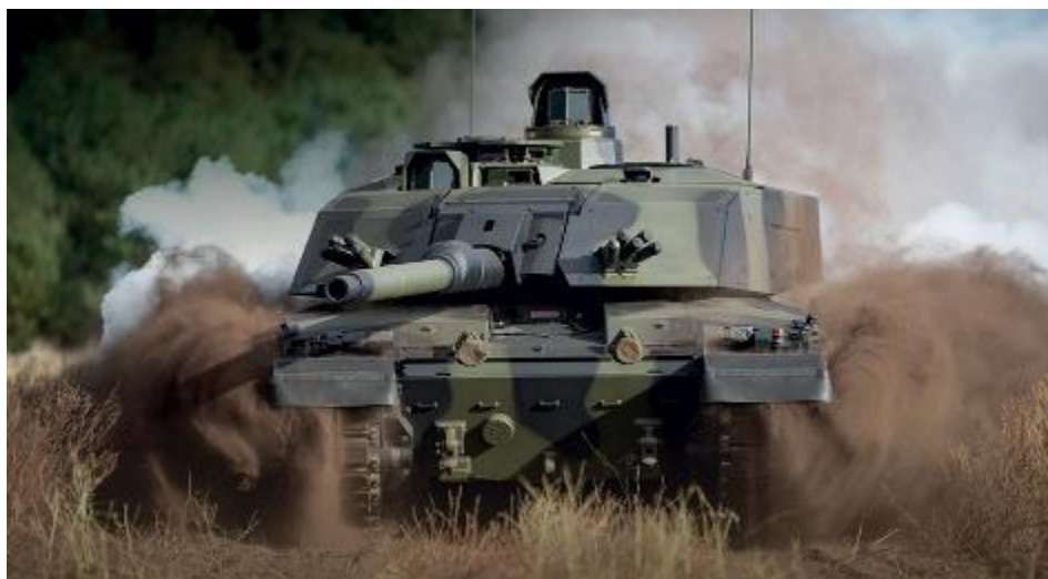
Предлог пакета Challenger 2 LEP подразумева потпуно нову куполу и нови топ са глатком цеви 120 mm
