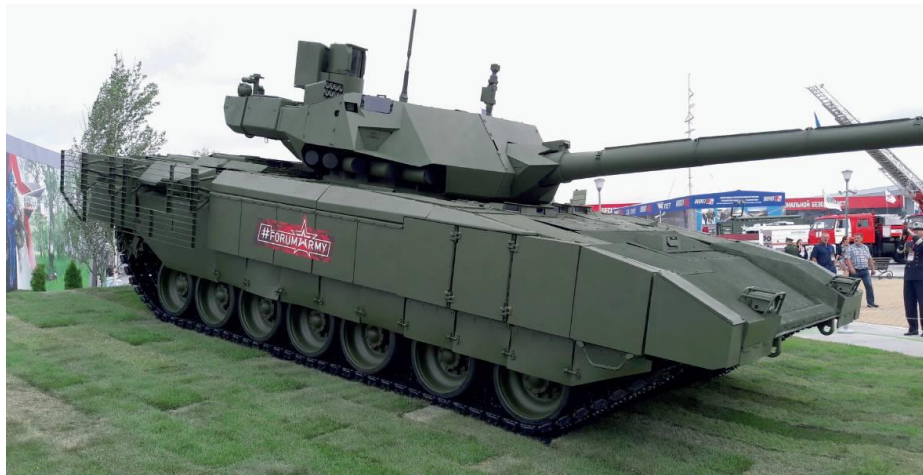
Упркос бројним предностима, потражња за тенковима Т-14 и даље је мала. Одређени системи тенка пребачени су на тенк Т-90М, као што су ДУБС и одређени делови куполе.
