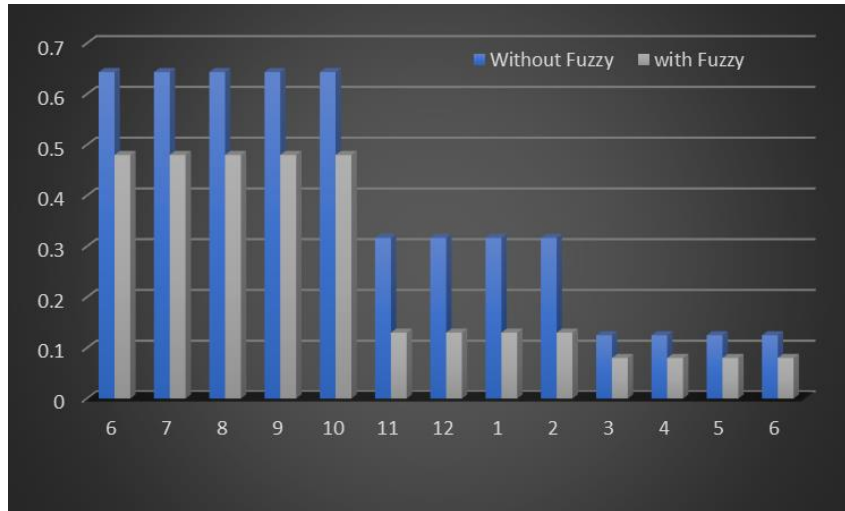
Figure 8 – Difference of SSL energy consumption with and without applying fuzzy logic Рус. 8 – Разница в энергопотреблении умной системы уличного освещения с применением нечеткой логики и без нее Слика 8 – Разлика у потрошњи енергије паметног система уличног осветљења са применом фази логики и без њене примене
