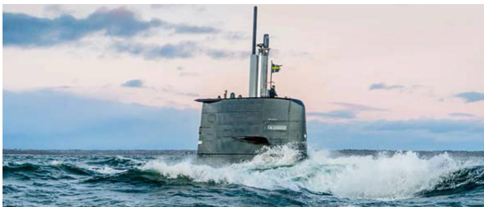
Подморница шведске морнарице класе Gotland користи погон независан од ваздуха Stirling, снаге 75 kW, који јој омогућује да се две недеље креће под водом брзином до 4 чвора
