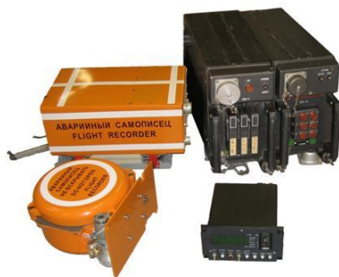
Figure 6 – Flight parameters recorder BUR-1-2 of the Mi-17V-5 helicopter Рис. 6 – Регистратор параметров полета БУР-1-2 вертолета Ми-17В-5 Слика 6 – Регистратор параметра лета БУР-1-2 хеликоптера Ми-17В-5 (in Serbian)
