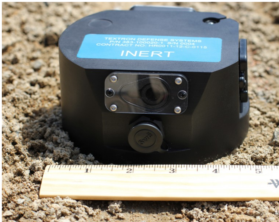
DARPA zemaljski senzor zasnovan na komercijalnom hardveru i softveru savremenih smartfona
