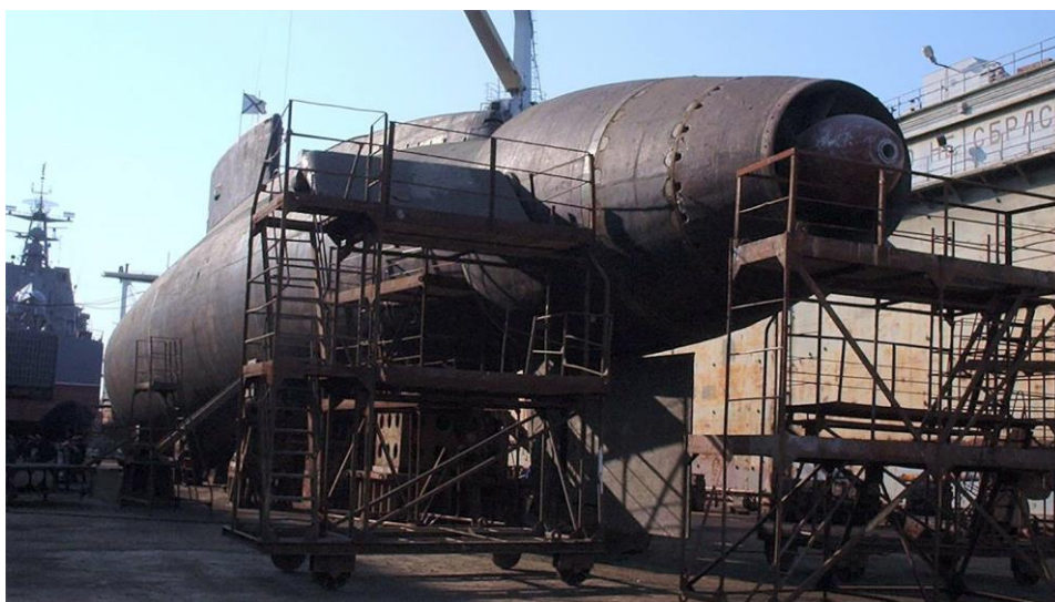
Alrosa , на сувом доку, открива детаље свог прилично напредног дизајна пумпно-млазног погона.
