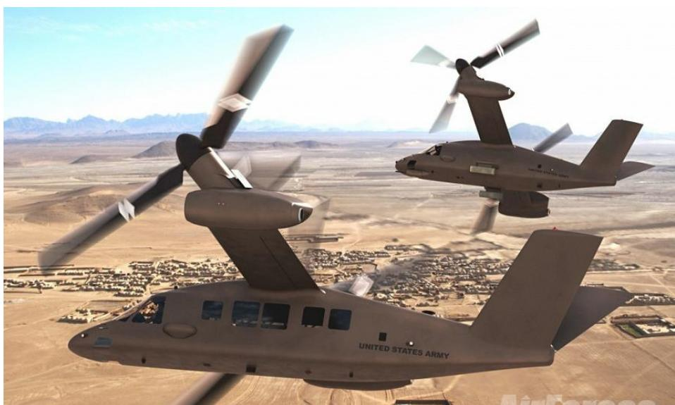
Prema izjavama predstavnika kompanije, težište u razvoju ove letelice biće na postizanju brzine krstarenja od 280 čvorova (odnosno 518,56 km/h), agilnosti pri malim brzinama, mogućnosti lebdenja pri visokim temperaturama, manevribilnosti pri velikim brzinama i višestrukom opterećenju, štedljivosti goriva, povećanom taktičkom radiusu, unapređenoj pouzdanosti i nižim troškovima operativne upotrebe.
