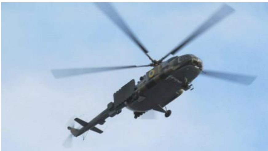
Модернизовани украјински хеликоптер Ми-8МТПВ са карактеристичним антенама монтираним на централном делу трупа
