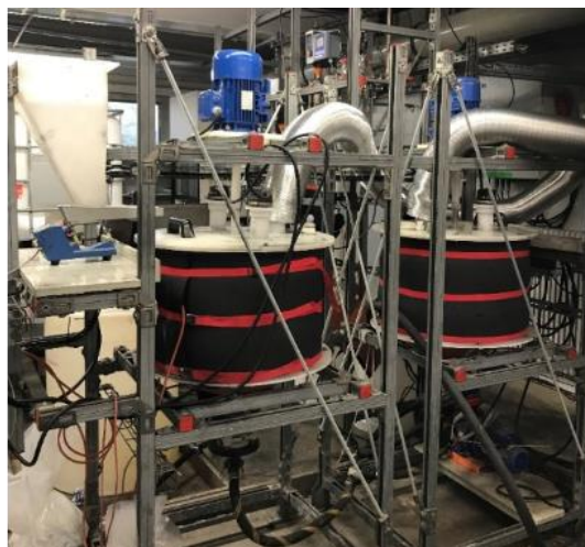
Figure 4 – Reactors for the dissolution of the black mass from used Li-ion batteries Рис. 4 – Реакторы для переработки черной массы из использованных литий-ионных аккумуляторов
