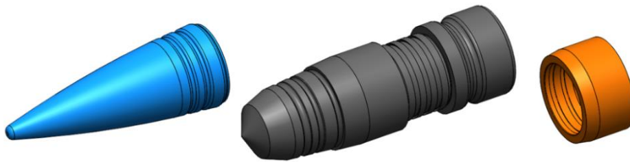
Figure 3 – 30mm projectile parts, 3D model Рис. 3 – Части снаряда 30мм, 3Д модель Слика 3 – Делови пројектила 30 мм, модел 3Д
