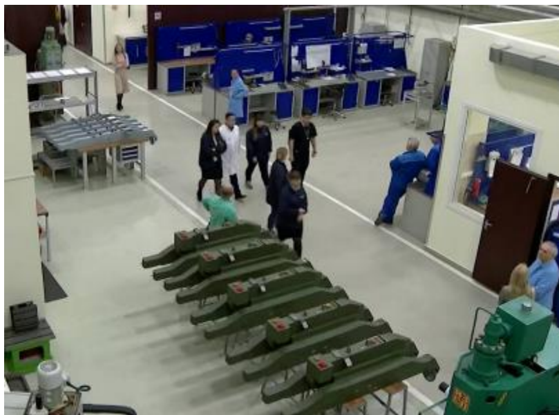
Производни погон компаније Vyprel у Москви где су приказани лансери за ракете LMUR , једноструке APU-305 (на крају) и двоструке APU-L (на почетку)
