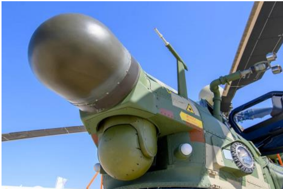
Лоптасти део на носу хеликоптера Mi-28NE носи даталинк AS-BPLA за комуникацију са ракетом LMUR
