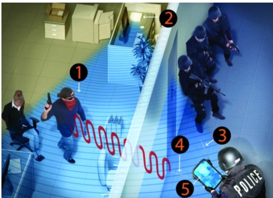
Radarski signal otkriva kretanje s druge strane zida, dok se infracrveni detektor koristi za detekciju toplote ljudskog tela
