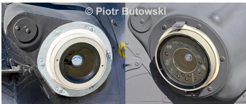
Ултраљубичасти сензори за упозорење на долазеће пројектиле – стандардни L370-2 (лево) и модернизовани L418-2 . Извор: Piotr Butowski
