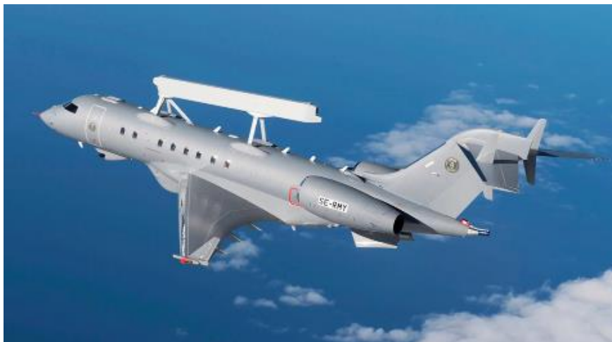
Saab GlobalEye, koji se zasniava na letelici Bombardier Global 6000/6500
