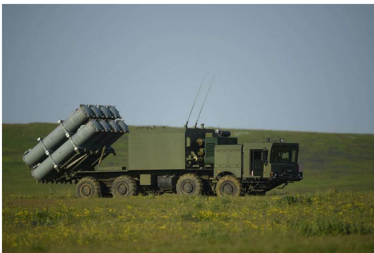
Систем Rubezh-M намењен је да допуни већи и скупљи обалски ракетни систем Bal, који може да прими до осам пројектила по лансеру.
