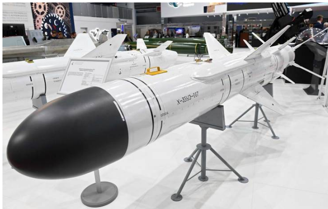
Ракета Kh-35UE, примарно наоружање система Rubezh-ME, има турбомлазни мотор мале величине, који постиже брзину од 0,8 до 0,85 Маха и домет лета до 260 километара за извозне верзије и до 450-500 км за домаће верзије.
