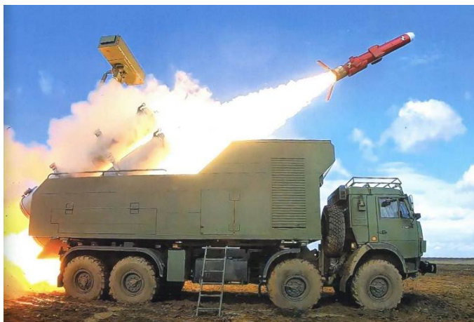
Обалски ракетни систем Rubezh-M, који користи противбродске ракете Kh-35U Uran, може да гађа површинске циљеве као што су бродови до 5.000 т
