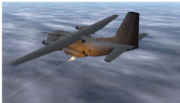
Italijani konvertuju šest aviona flote koju čini 12 letelica *Alenia C-27J Spartan*, taktičkih transportnih aviona, u višenamenski avion MC-27J *Pretorian*. Konvertovanje se čini putem paletizovanih kompleta koje su zajednički razvili kompanije *Alenia Aeromacchi*, *ATK* i *Selex ES*. Ključni elementi sistema uključuju paletizovan top od 30 mm GAU-23, kompanije *ATK* koji gađa sa bočne strane aviona, sa vrata predviđenih za iskakanje padobranaca, elektro-optičke kamere i kompjuterski sistem.
