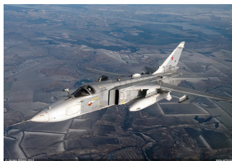
Ruski avion Su-24MR na kom je, umesto oružja, postavljen sistem za protivelektronska dejstva
