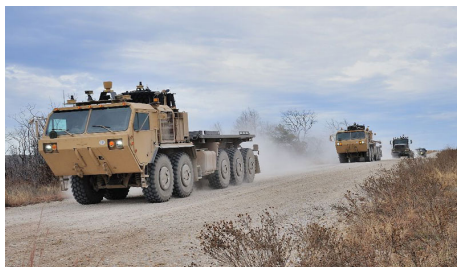
Tehnologiju naprednog autonomnog sistema za vojne kolone AMAS, predstavljena najpre u Fort Hudu a potom i u Dalasu, januara 2014. godine pokazala je visok nivo autonomnog kretanja vojnih kolona u urbanim sredinama, sa više vozila različitih modela
