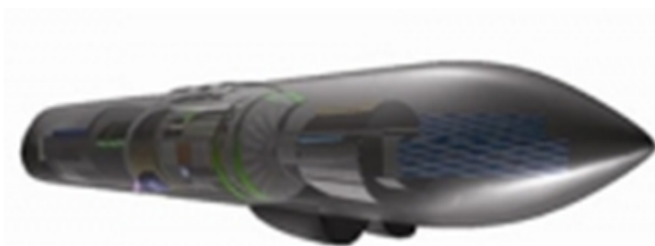
Američka verzija kontejnera za protivelektronska dejstva, za avion „Growler“, sistema koji će biti operativan 2020. godine
