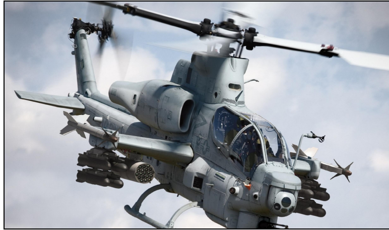
Slika 4 – Helikopter AH-1Z Viper „Zulu Cobra” Figure 4 – Helicopter AH-1Z Viper „Zulu Cobra” Рис.4 – Ударный вертолет Bell AH-1Z Viper «Zulu Cobra»
