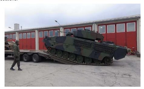
Figure 2 – Evacuation of a combat vehicle by a towing train Puc. 3 – Эвакуация боевого транспортного средства буксирным составом Слика 3 – Евакуација борбеног возила вучним возом
