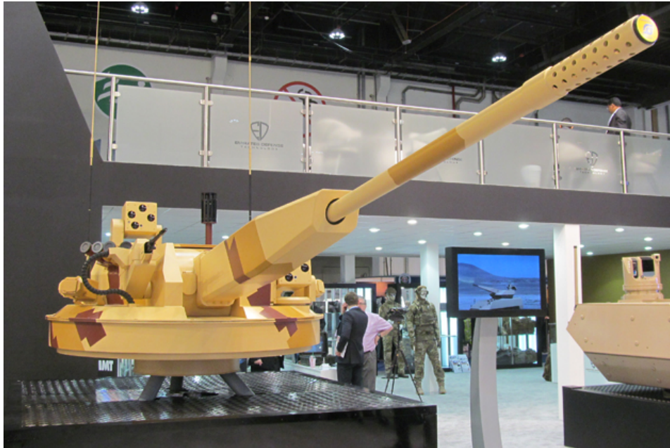
Купола АУ-220М наоружана олученим топом 57 мм
