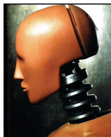
Figure 8 – Neck for crash-test dummies Рус. 8 – Шея манекенов, используемых в дорожно-транспортных краш-тестах Слика 8 – Врат за лутке које се користе при тестирању саобраћајних несрећа
