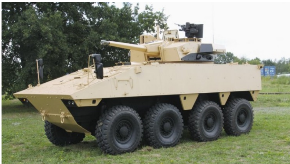
Најновија верзија VBCI-2 опремљена је најновијом куполом Т 40 наоружаном топом СТАИ 40 mm
