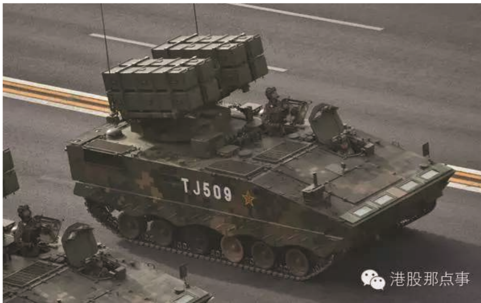
Систем противоклопних ракета „Црвена стрела 10” наоружан новим моделима пројектила, постављен на шасију пешадијског оклопног возила ЗБД-04А
