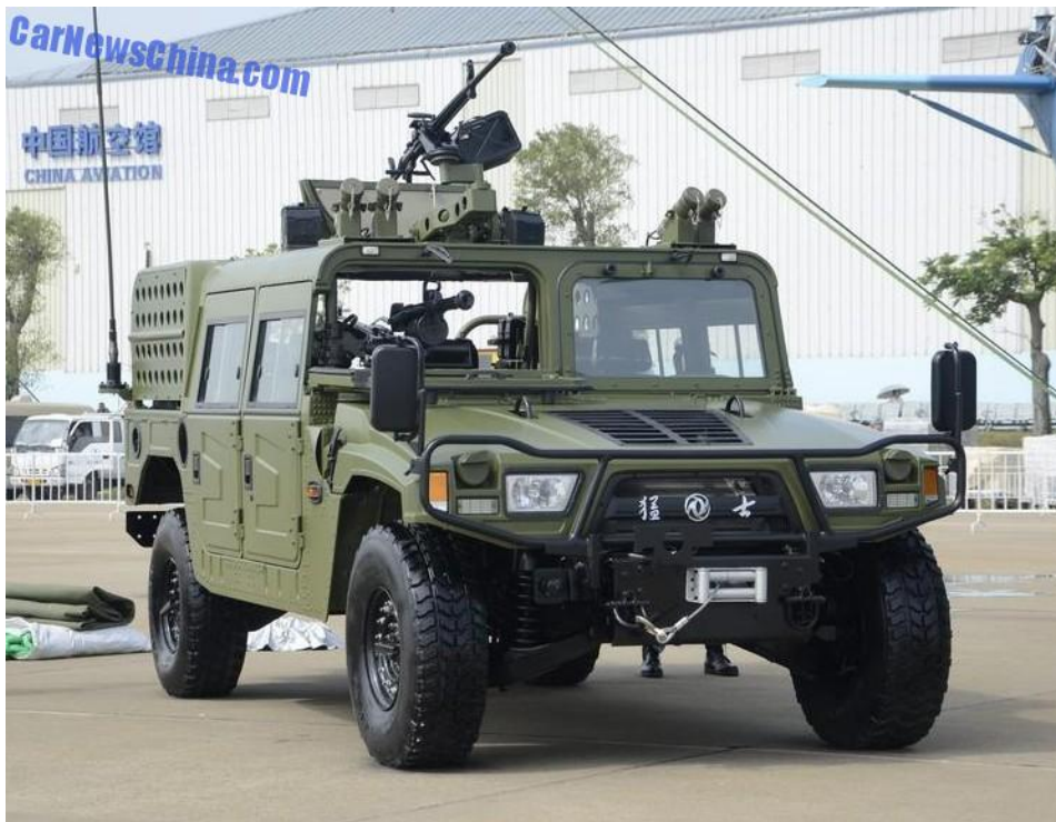
CSK002 у конфигурацији 4x4 базиран на возилу DongFeng EQ2025 намењен ваздушнодесантним трупима
