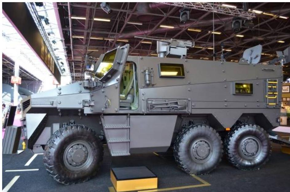
Renoova podružnica za proizvodnju vojnih teretnih vozila (*Renault Trucks Defence – RTD*) na izložbi NVO „Evrosatori“ (*Eurosatory 2014*) u Parizu prikazala je svoje novo oklopno vozilo u konfiguraciji 6x6 pod oznakom BMX-01. Vozilo je konstruisano kao demonstrator za budući program francuske Kopnene vojske (*Armée de Terre*) VBMR, odnosno višenamensko oklopno vozilo smanjenog rizika.
