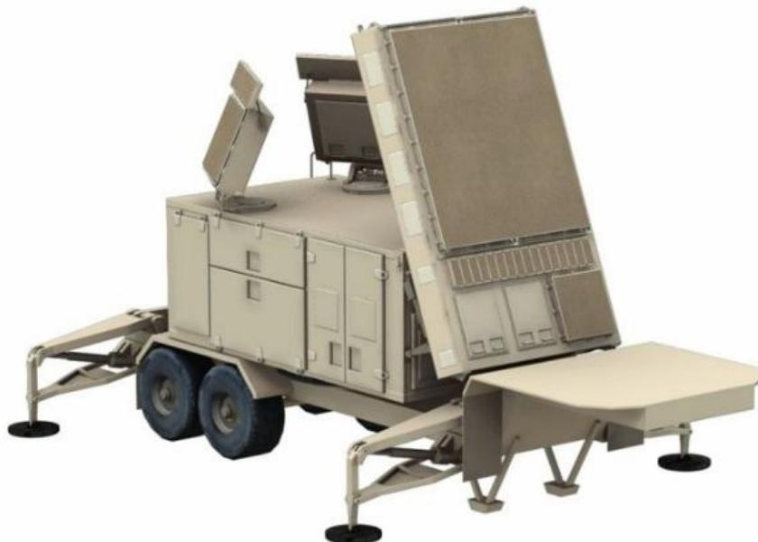
Američka kompanija Rajtheon (*Raytheon*), u okviru programa modernizovanog raketnog sistema za protivvazduhoplovna i protivraketna dejstva velikog dometa *patriot* PAC-3 MSE (*Patriot Advanced Capability-3 Missile Segment Enhancement*), razvija i novi radar, navodno vrhunske tehnologije, sa tri rešetke sa aktivnim elektronskim skeiranjem (*AESA*) koji pokriva 360 stepeni. Osnovni cilj modernizacije je otklanjanje „tradicionalnih“ nedostataka radarske komponente ovog raketnog sistema.
