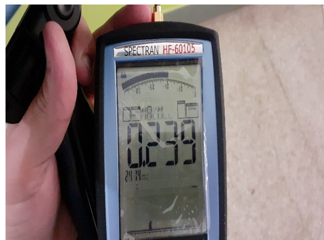
Slika 3b. Primer merenja jačine električnog polja uz pomoć instrumenta Spectran HF 60105
